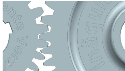
Abbildung 1: Ausführung einer inäquidistanten Verzahnung mit unregelmäßigen Zahnabständen und Zahndicken
